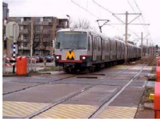
A rotterdami metró egy belső és egy külső szakasza Az alkalmazott szerelvény mind alsó, mind felső táplálással képes működni
