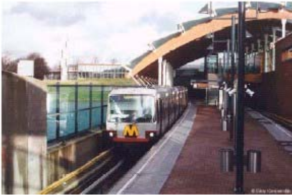
A rotterdami metró egy belső és egy külső szakasza Az alkalmazott szerelvény mind alsó, mind felső táplálással képes működni
